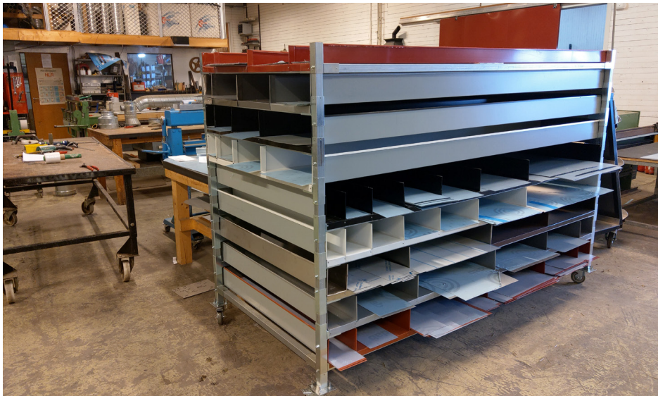
Sagen Blick AS hefur prófað þessa samsetningu sem millistöð fyrir úrgangsefni. Brotamálmur er flokkaður eftir litum og gerðum og er geymdur við hlið skurðarvélanna.
