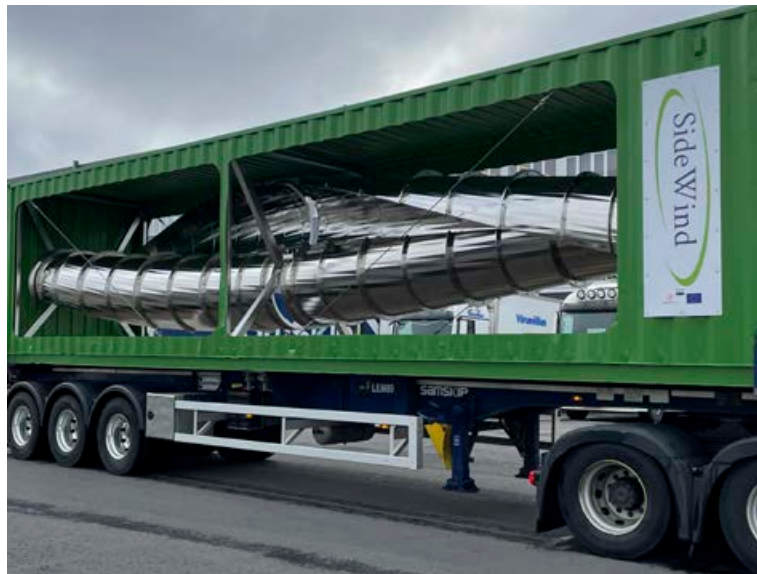
Vindmylla er sett lárétt inn í gám og tengd við rafal sem er staðsettur þar.
