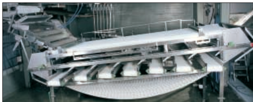
Stærðarflokkunarvélin fyrir loðnu og síld, þróuð og smíðuð af Style Int.
